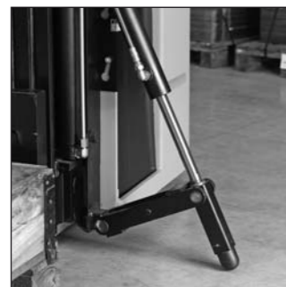
Die Resttragkraft bei größeren Hubhöhen kann mit Seitenstabilisatoren (standardmäßig beim Triplexmast) erhöht werden.
