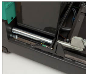
Batterie auf Rollen
