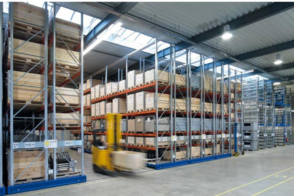
Warenbewegung mit Schubmaststapler im geöffneten Gang, rechts im Bild eine dreigeschossige META-Fachbodenregalanlage für die Lagerung von Kleinteilen
