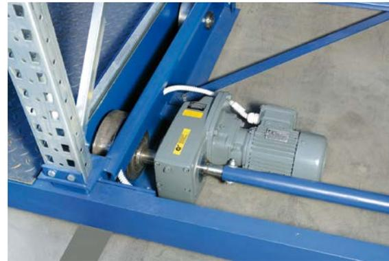
Detailansicht des leistungsstarken und wartungsfreien Getriebemotors
