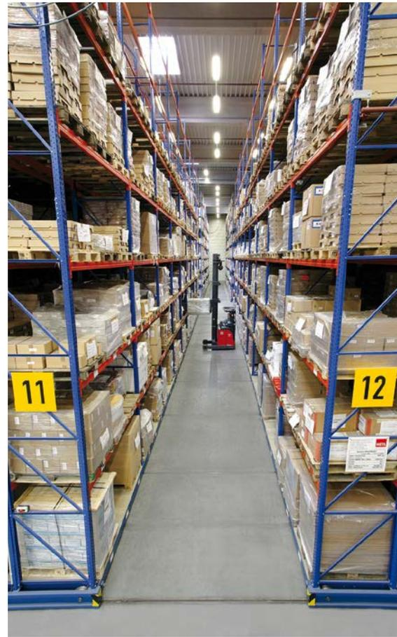
*Bedienung mit Schubmaststapler bis 10 m Höhe*
