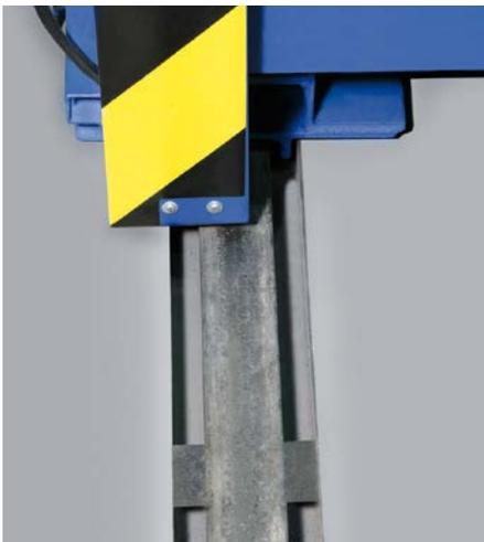
Endanschläge in der Führungsschiene
