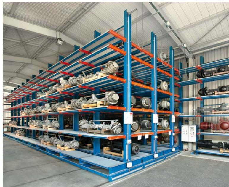
Kragarmregale mit Gitterrostabdeckung – so entsteht eine durchgehende Ablagefläche. Ideal für Lagergut mit unterschiedlichen Abmessungen.
