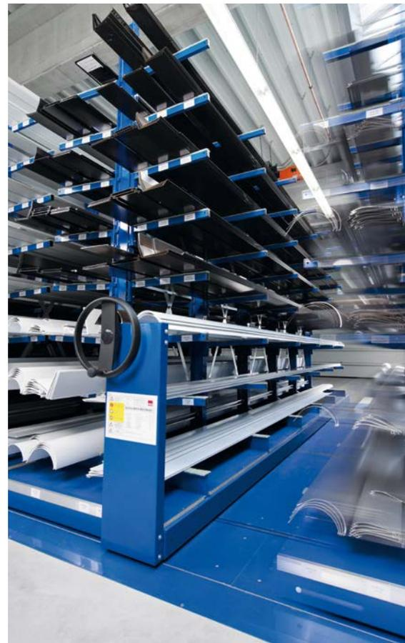
*Ohne Kraftaufwand lassen sich ein oder mehrere Verfahrwagen gleichzeitig verschieben*
