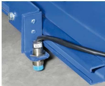
Endabschalter (Induktivschalter) an den beiden äußeren Wagen
