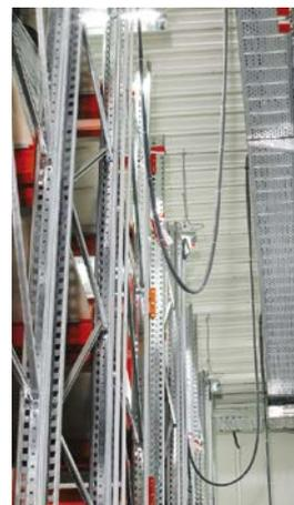
Stromzuführung an der Rückseite der Fahrwagen
