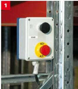
1 NOT-AUS-Schalter / Bedientaster an jedem Fahrwagen
