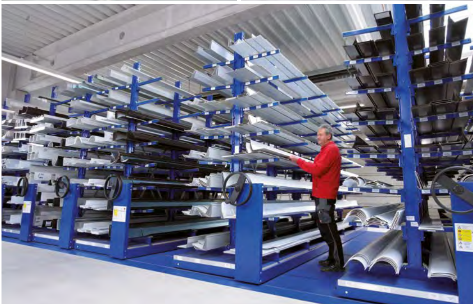
META MULTIBLOC verfahrbare Kragarmregale: die oberen beiden Reihen zeigen die Variante Schwer mit elektromotorischem Antrieb, die untere Reihe zeigt die Variante Leicht mit manuellem Antrieb
