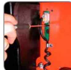
Einfache Einstellung des Kippwinkels und der Drehgeschwindigkeit.
